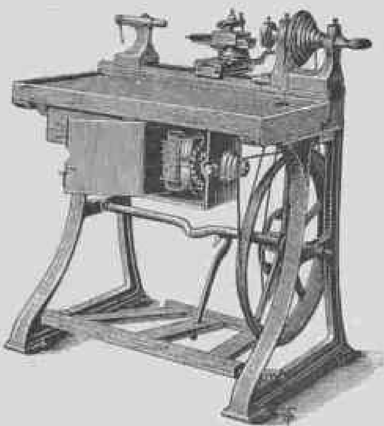
Токарный станокъ съ электродвигателемъ.
